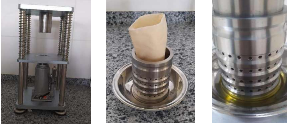
Şekil 5. Vişne çekirdeklerinden mekanik presleme yöntemiyle yağ ekstraksiyonu
