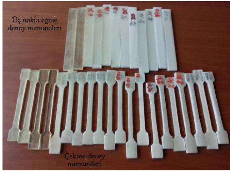
Şekil 5. Çekme ve üç nokta eğilme deneyleri için üretilen bazı numuneler
