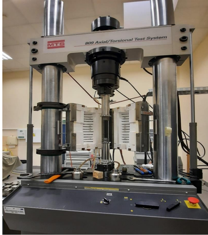
Şekil 3. Farklı sıcaklıklarda yapılan sürünme deneyi düzeneği
