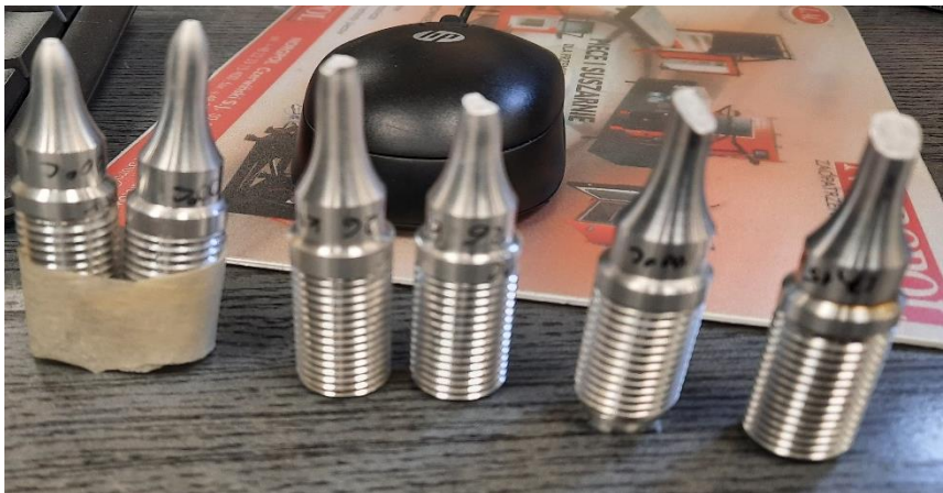
Şekil 4. Sırasıyla 300 °C, 200 °C ve 100 °C’de kırılmış numunelerin genel görünüşü
