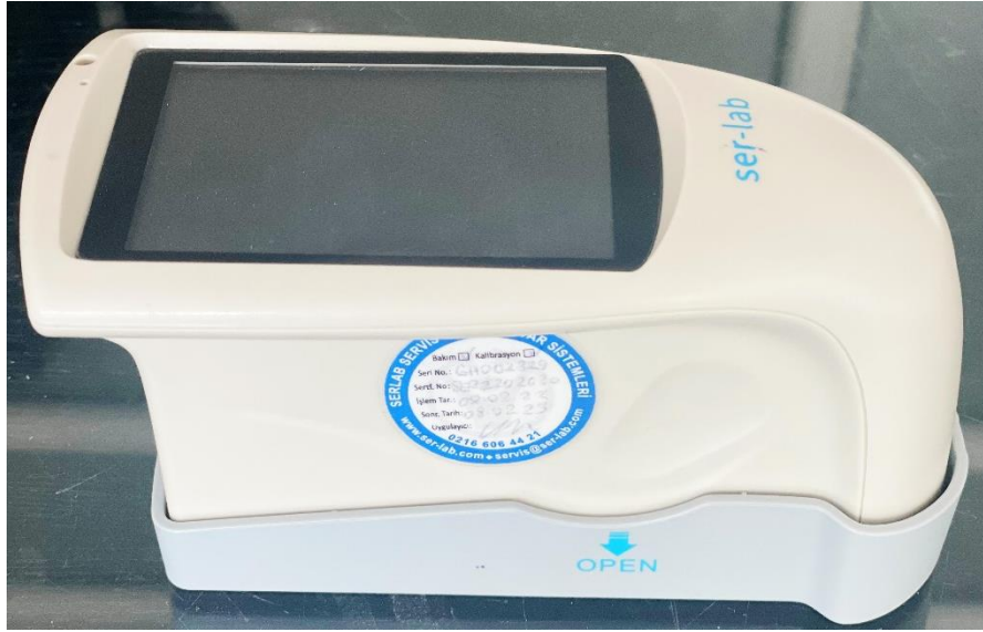
Şekil 5. Parlaklık ölçüm cihazı (glossmetre)
