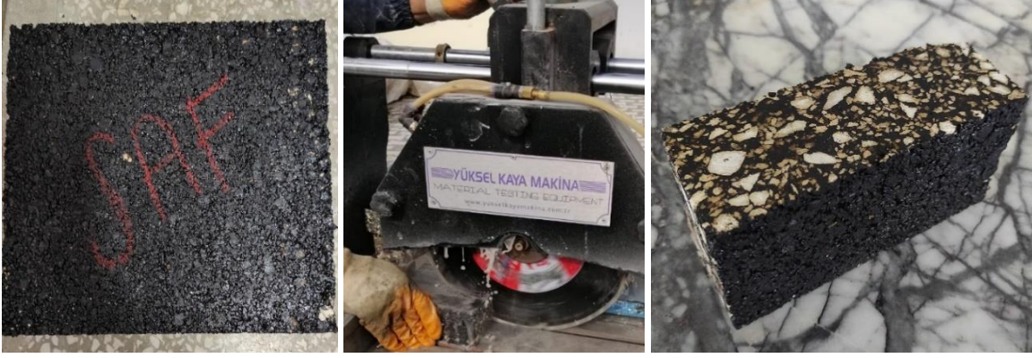
Şekil 2. Numunelerin kesilmesi ve numune örneği
